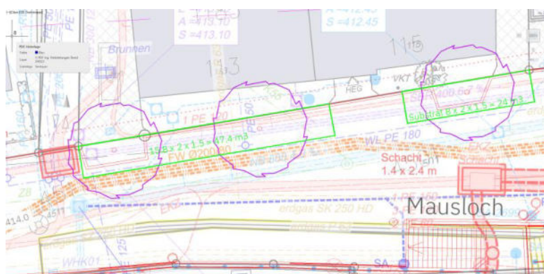
Abbildung 21: Abgleich Bäume und Werkleitungen Variante 3a
