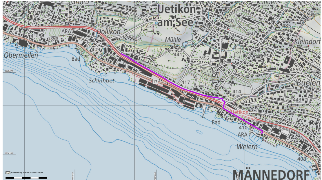
Abbildung 35: Übersichtskarte Linienführung Druckleitung ARA Männedorf bis Kanalnetz Meilen
