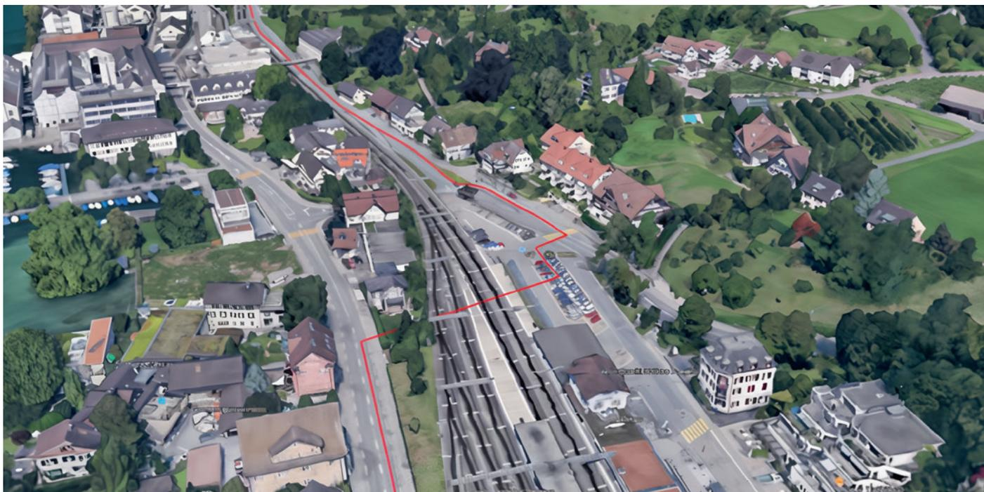
Abbildung 6: Luftaufnahme: Gleisunterquerung Bahnhof Uetikon Druckleitung im Pressbohrverfahren
