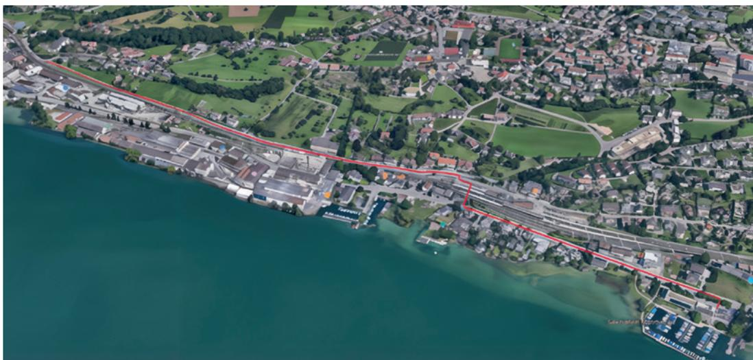
Abbildung 5: Flugfotos Linienführung Druckleitung ARA Männedorf bis Verbandskanal in Uetikon
