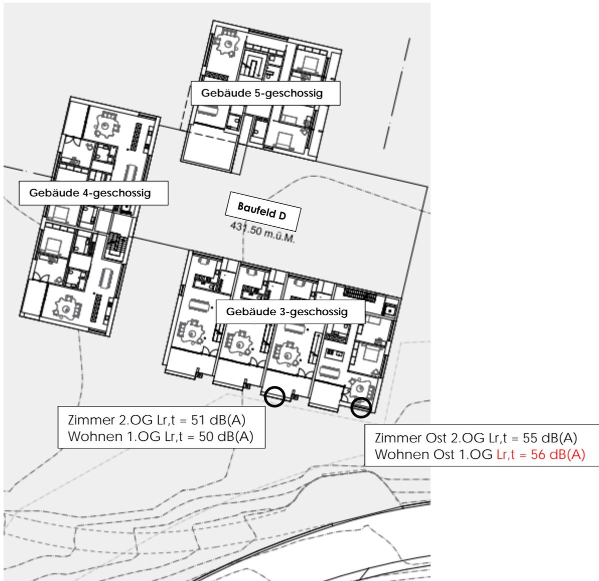
Als Lärmschutzmassnahme beim 3-geschossigen Gebäude ist eine Glasbrüstung auf der Sockelmauer mit Höhe auf 433 m ü.M. vorgesehen. Die Länge der Glasbrüstung beträgt hier 19 m (Skizze der Glasbrüstung siehe Seite 11). Durch diesen Glasaufsatz reduzieren sich die Beurteilungspegel um bis zu 3 dB.
